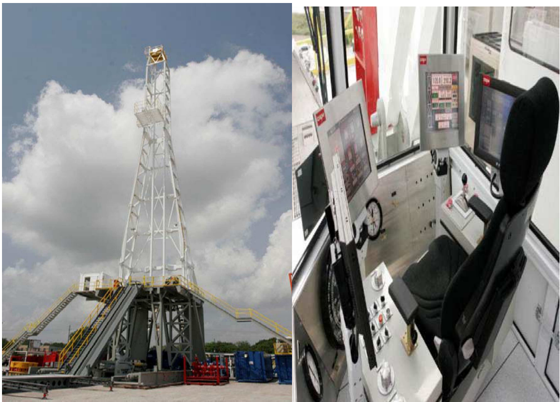
Figura 6. Equipo de perforación de 2000 HP AC
