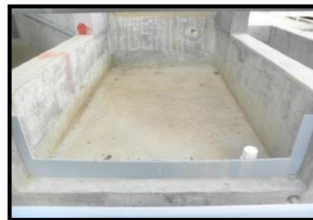
Imagen 24. Vertedero rectangular con contracción. n=2
