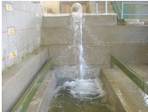
Foto 2. Afectación a los taludes para un Q=90 \text{ m}^3/\text{s}
