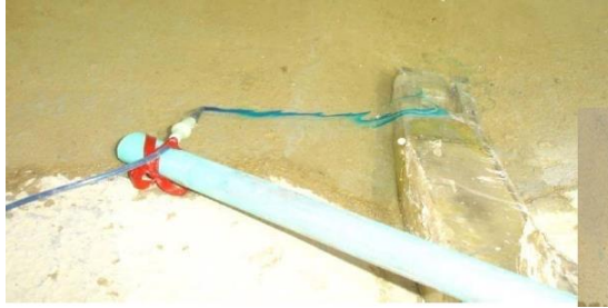
Foto 7. Líneas de flujo en la toma No1 para un Q = 3,2 \text{ m}^3/\text{s}
