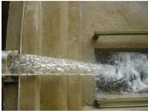
Foto 4. Afectación a los taludes para un Q=145 \text{ m}^3/\text{s}
