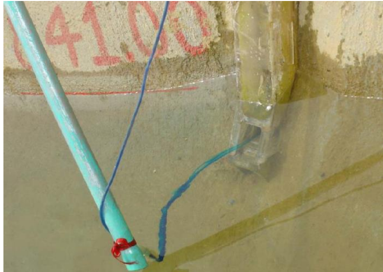
Foto 13. Líneas de flujo en la toma No 1 para un Q = 11 \text{ m}^3/\text{s}
