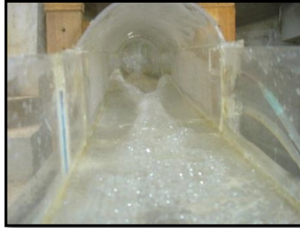
Foto 13. Formación Diamante a lo largo del canal de excesos Q=95 \text{ m}^3/\text{s}
