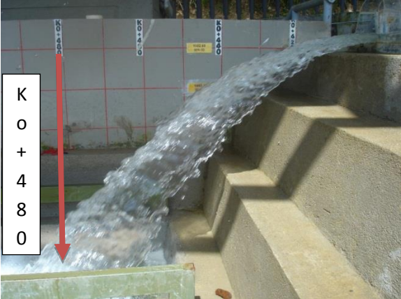
Foto 5. Alcance del lanzamiento para un Q=270 \text{ m}^3
