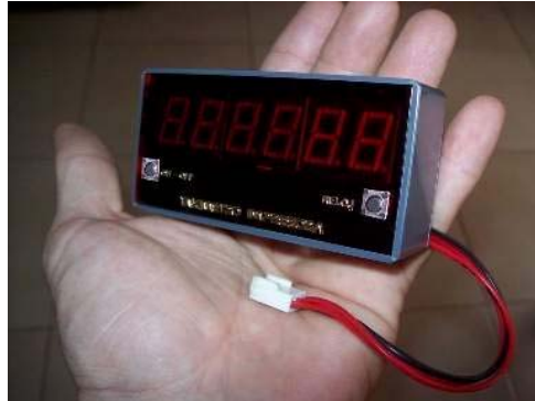
Foto figura 2. Odómetro vehicular.
