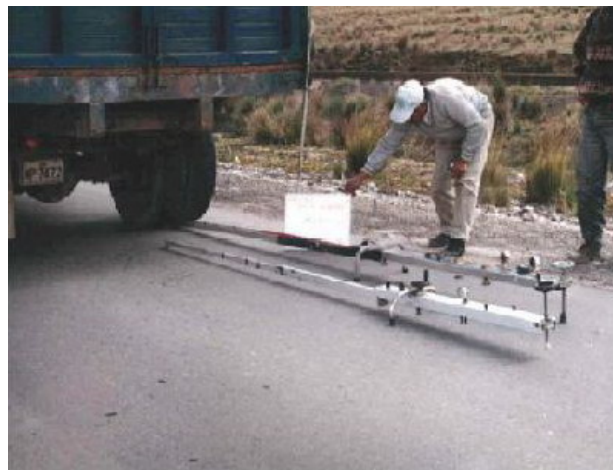
Figura 4. Ensayo de viga Benkelman.
