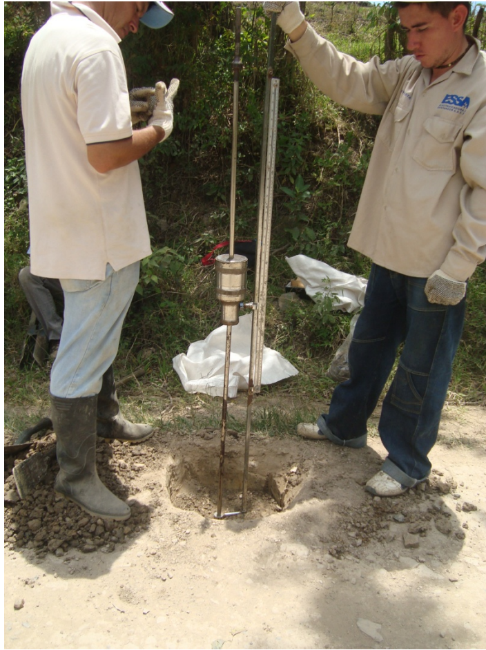
Figura 5. Ensayo de penetrómetro de cono.
