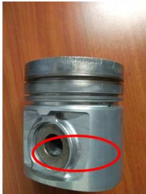
Figura 19. Pistón con marcas de ataque
