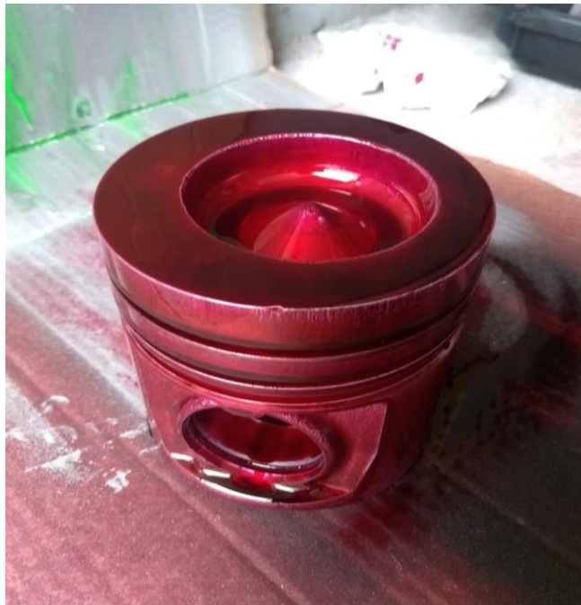
Figura 27. Aplicación del penetrante rojo en pistón
