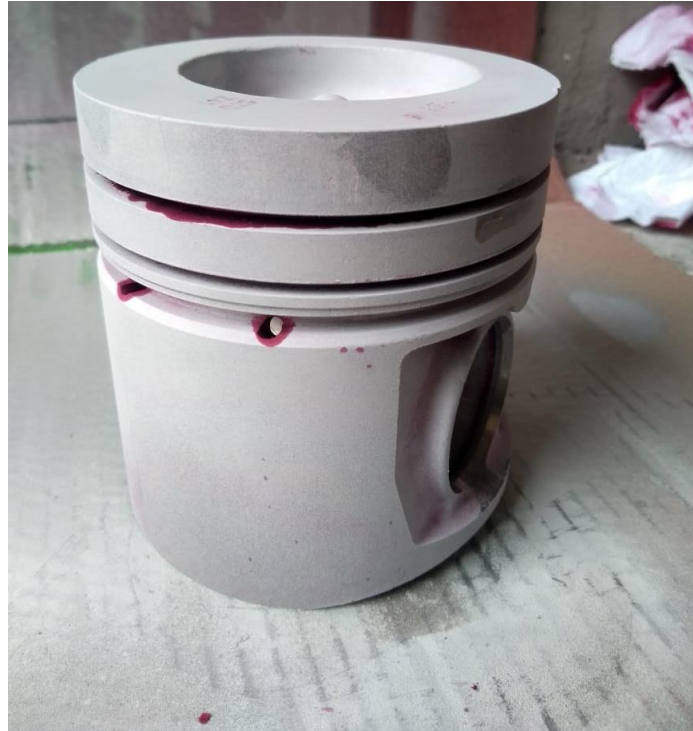
Figura 28. Aplicación del revelador en pistón
