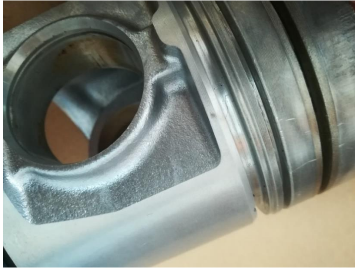
Figura 22. Evidencias de presencia de posibles grietas en alojamiento de anillos
