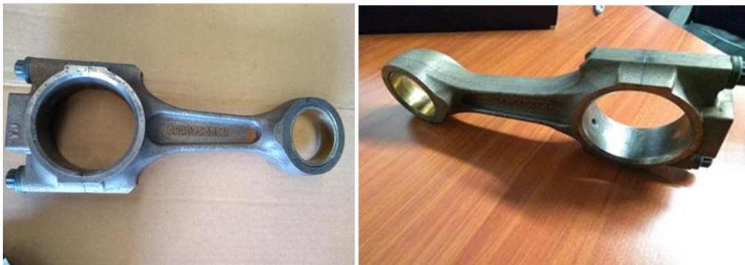
Figura 60. Fallo por pandeo en biela
