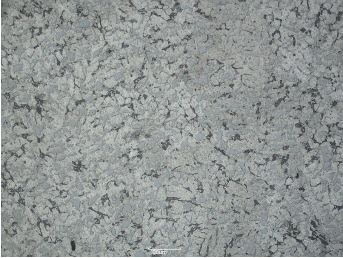
Figura 56. Estructura metalográfica del pistón toma 1
