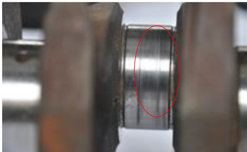
Figura 35. Deslizamiento de la superficie del muñón de biela
