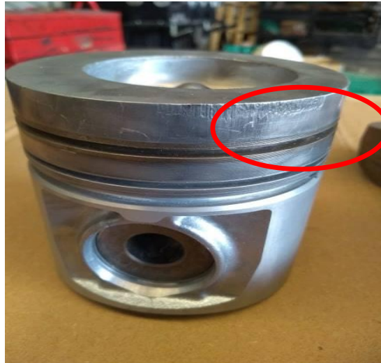
Figura 18. Pistón en estudio fallo superficie superior de anillos
