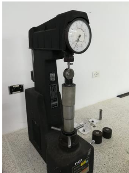
Figura 37. Montaje de ensayo de dureza 1.
