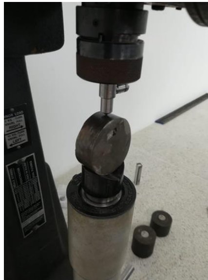
Figura 38. Aplicación de ensayo de dureza en superficie fallada
