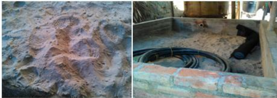
Figura 4. Arena cianurada ubicada en la planta La Bodega
