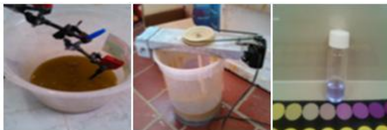
Figura 11. Proceso de determinación de cianuro libre en prueba con control de pH y agitación mecánica
