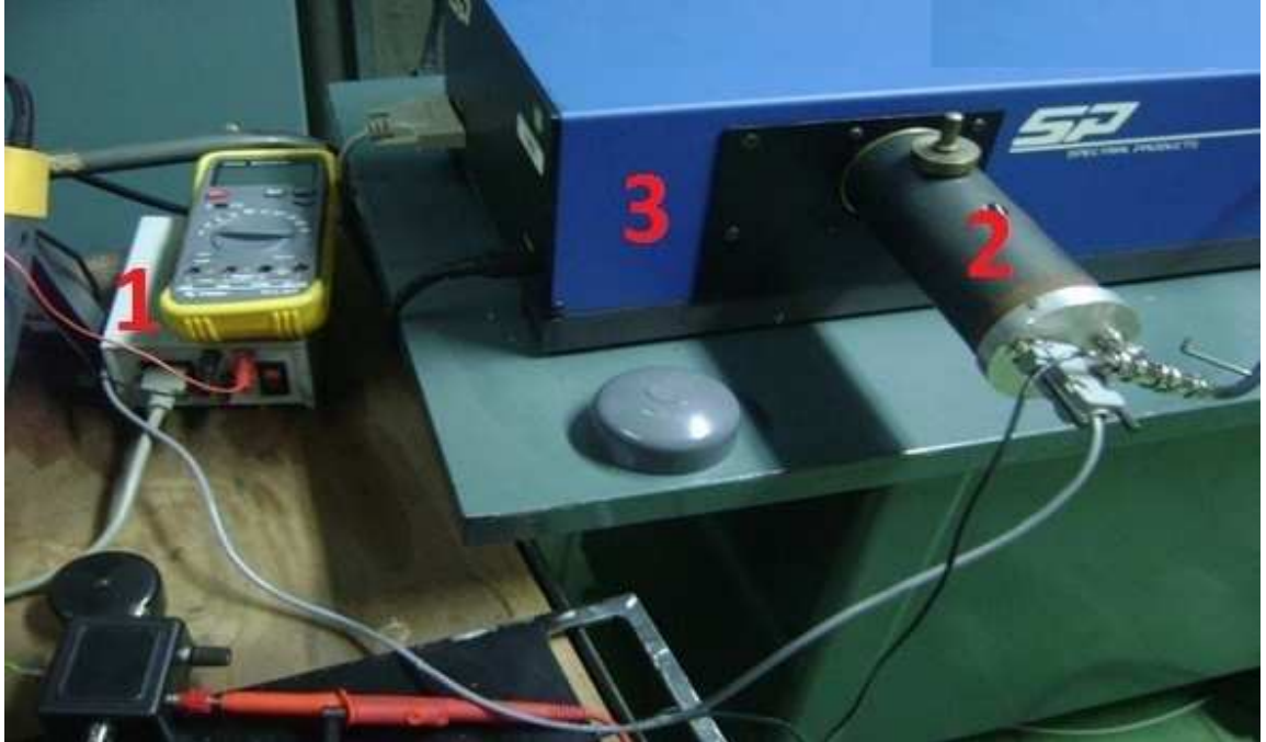
Figura 10. Montaje del fotomultiplicador en el cual se muestra la ubicación en el monocromador: 1.Fuente de energía. 2.Fotomultiplicador. y 3.Monocromador.
