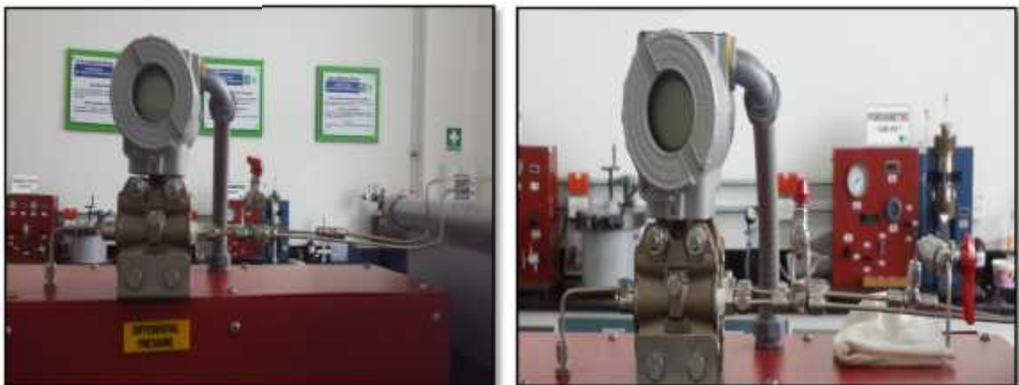
Figura 12. Modificación al equipo (válvula toma muestra)
