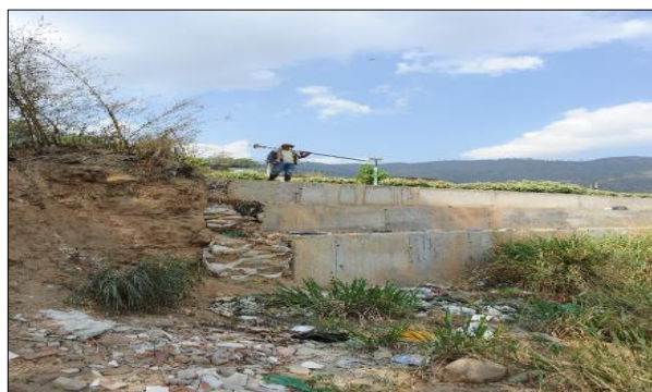
Figura 3. Levantamiento con TLS.
