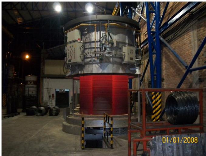
Figura 5. Horno proceso de recocido
