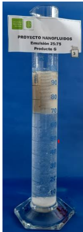
Figura 36. Prueba de emulsión, proporción 25:75
