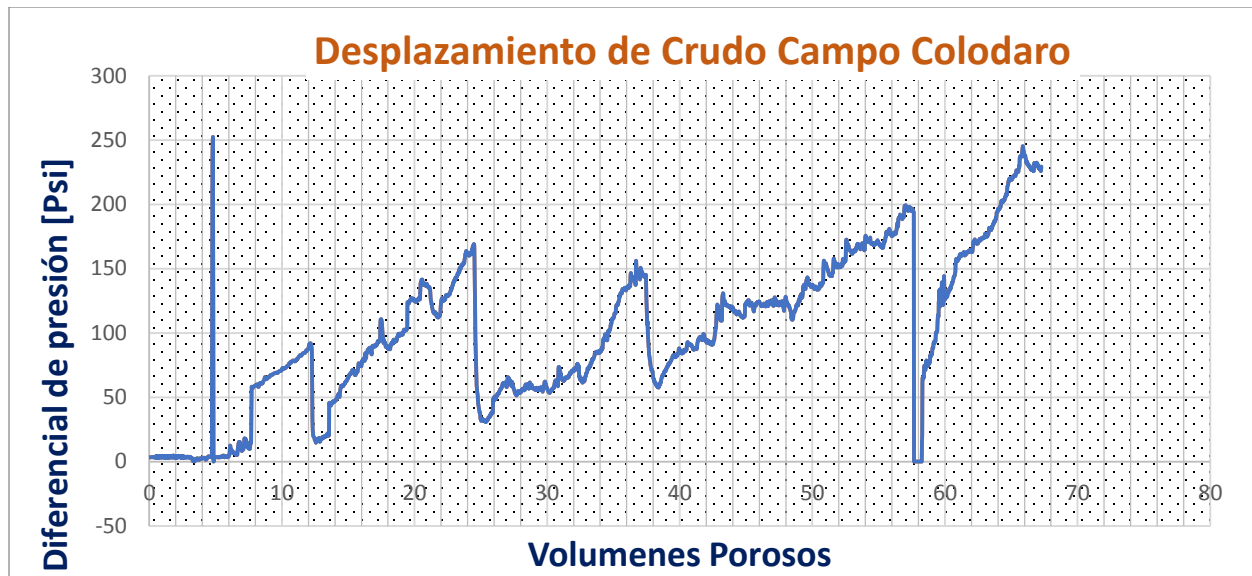
Figura 47. Gráfica delta de presión-volúmenes porosos del crudo, desplazamiento 2
