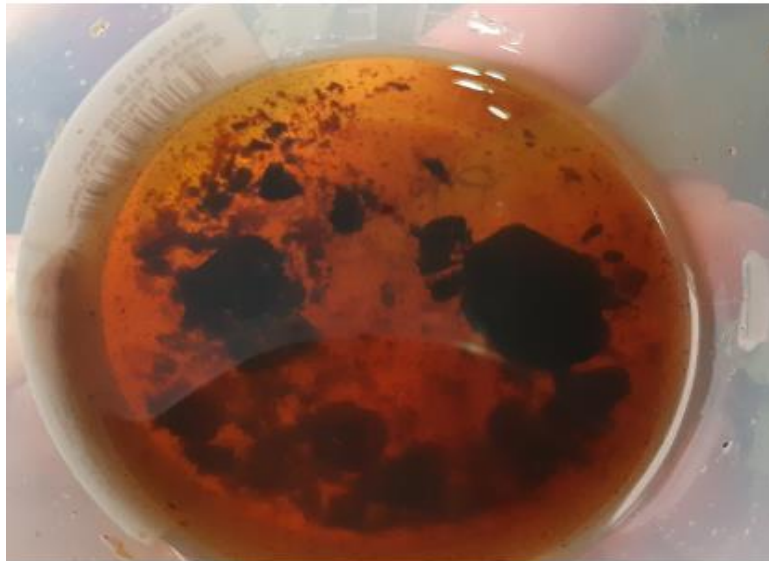
Figura 7. Crudo parafínico en estado sólido inmerso en fluido nanoestructurado.
