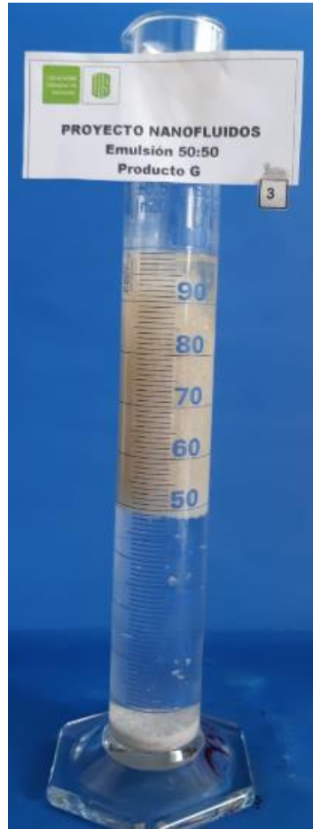
Figura 37. Prueba de emulsión, proporción 50:50
