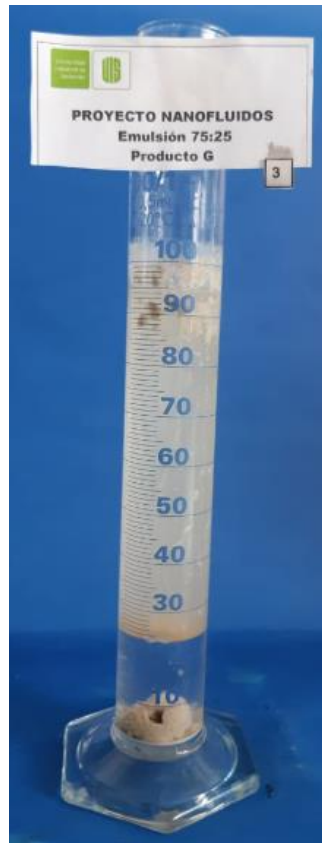
Figura 38. Prueba de emulsión, proporción 75:25
