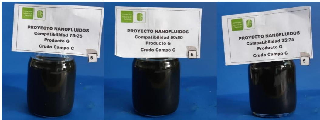
Figura 40. Compatibilidad fluido-fluido crudo - producto
