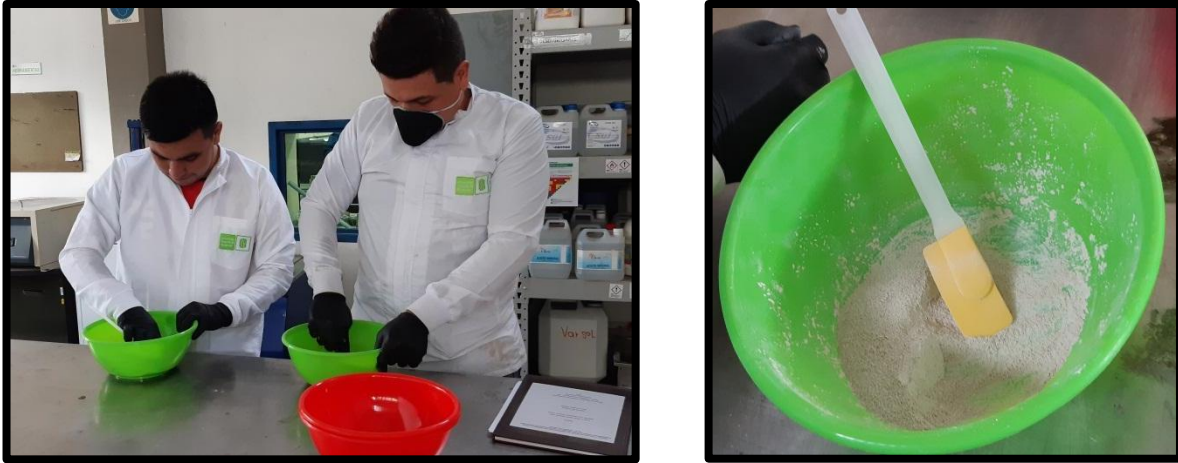
Figura 20. Mezcla en seco de la arena y el caolín- construcción de plugs sintéticos.
