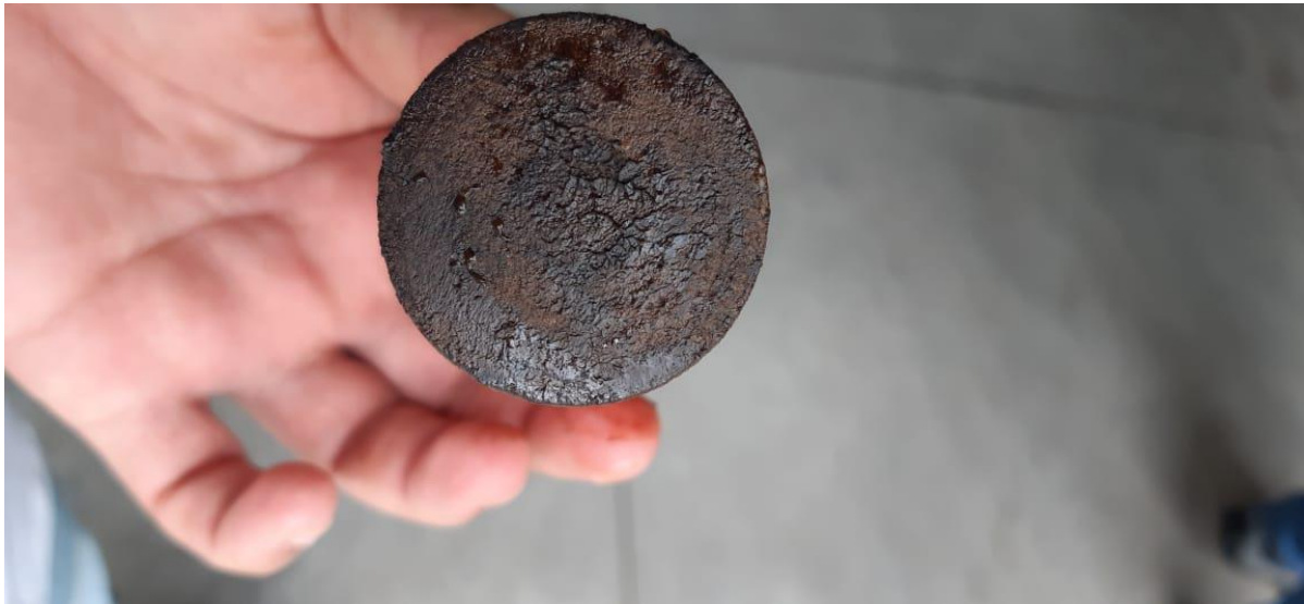
Figura 48. Plug con daño severo.
