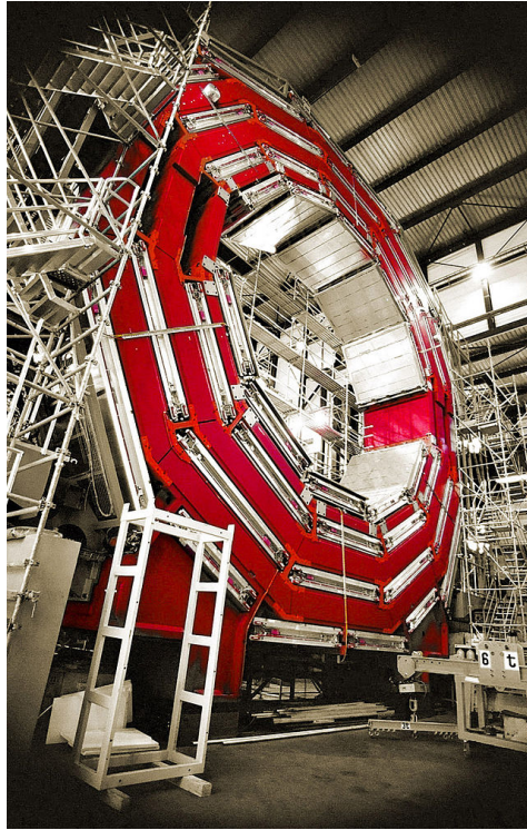
Figura 32: Parte del soporte del imán, con tubos de deriva y cámaras de placas resistivas, en la zona del barril.
