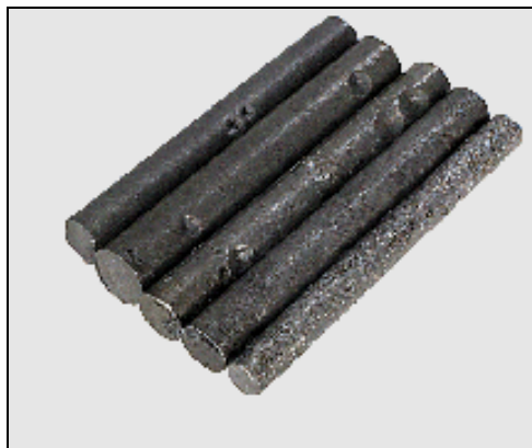
Figura 2. Corrosión localizada en ambientes acuosos con H 2 S. Http://www.norrisrods.com/spanish/failureanalysis-s.html .
