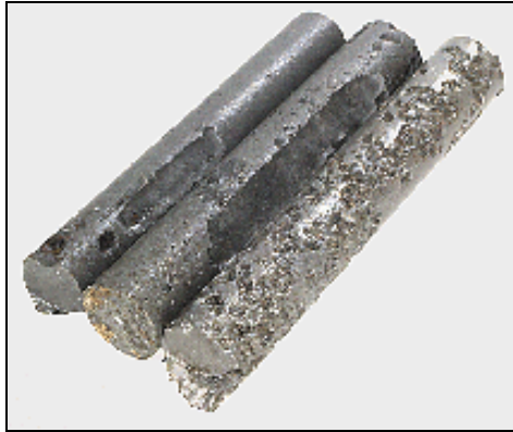
Figura 1. Corrosión localizada en ambientes acuosos con CO 2 . Http://www.norrisrods.com/spanish/failureanalysis-s.html .
