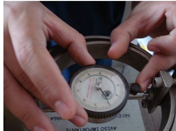
Fotos 2.5-26 y 2.5-27: Brazo de carga contra parte móvil de la caja y Lector de carga en ceros.
