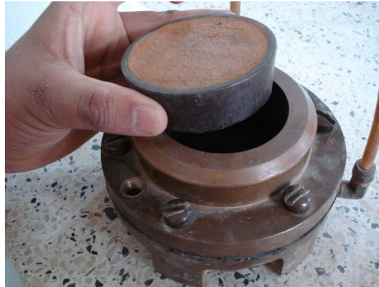
Foto 2.11-20: Colocación del anillo mas muestra.
