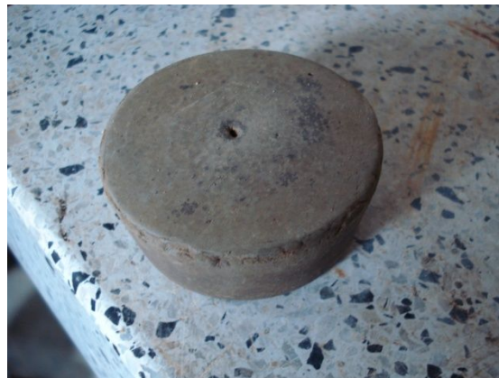
Fotos 2.4.3-9: Caucho para extracción de la Muestra
