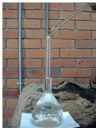
Foto 2.10-14 y 2.10-15: Nivel del agua concordando con la marca de calibración.
