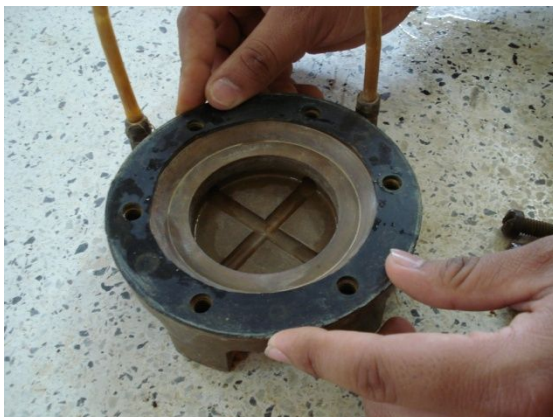
Foto 2.11-15 y 2.11-16: Preparación del Consolidómetro.
