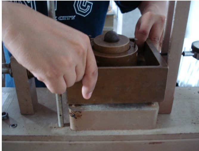
Foto 2.5-20: Ensamble de caja a máquina de ensayo.
