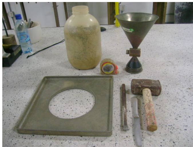
Foto 2.8-1: Dispositivo de cono de arena, cinta métrica y utensilios.
