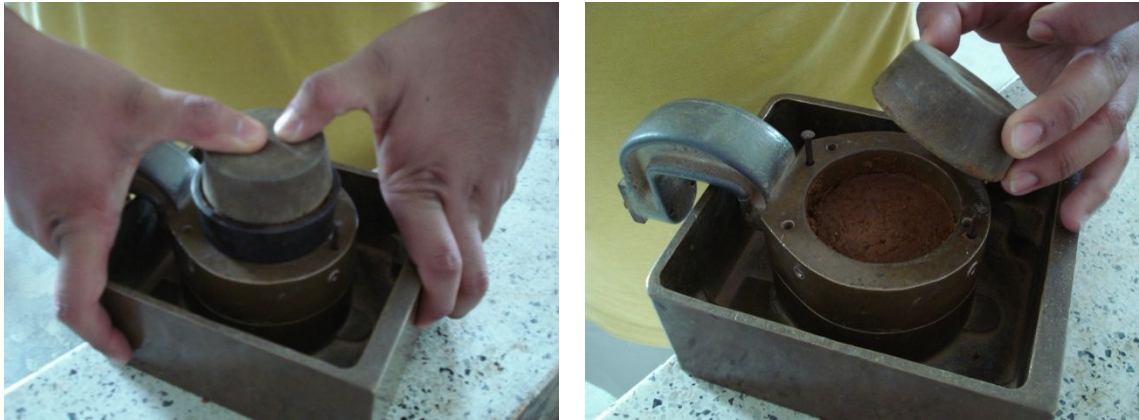
Fotos 2.5-17 y 2.5-18: Introducción de la muestra en la caja.
