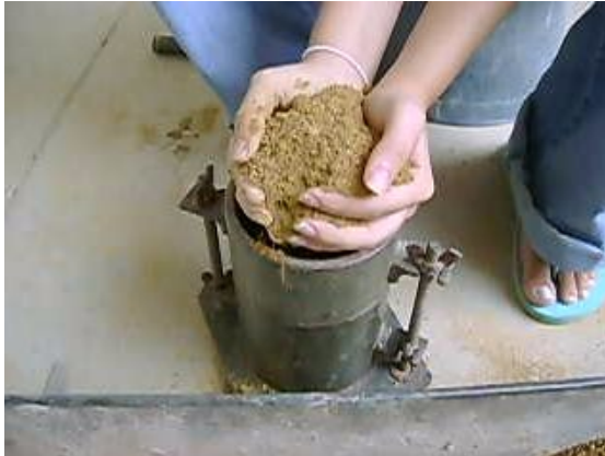
Foto 2.7-17 y 2.7-18: Vaciado de muestra en molde.
