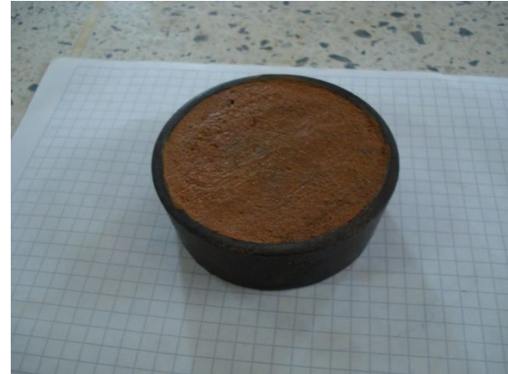
Foto 2.11-13 y 2.11-14: Extracción del anillo mas muestra.
