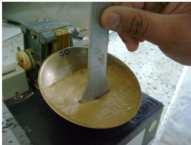
Foto 2.4.1-17: Medición de espesor de 1 cm con el calibrador
