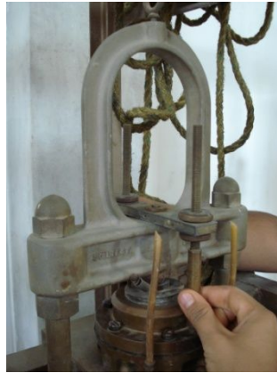
Foto 2.11-27: Ajuste del soporte del extensómetro.
