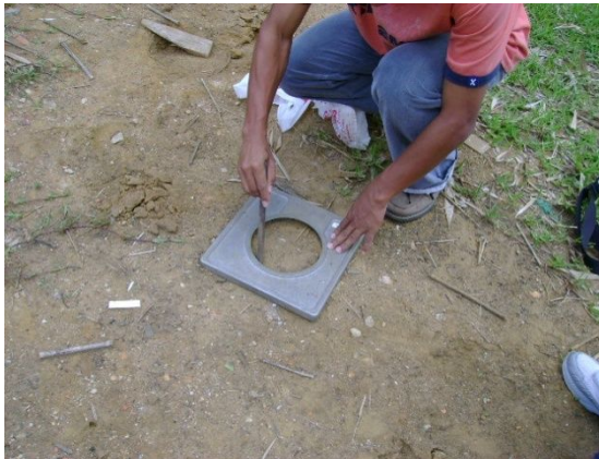
Foto 2.8-9 y 2.8-10: Demarcación, excavación y toma de muestra del hueco
