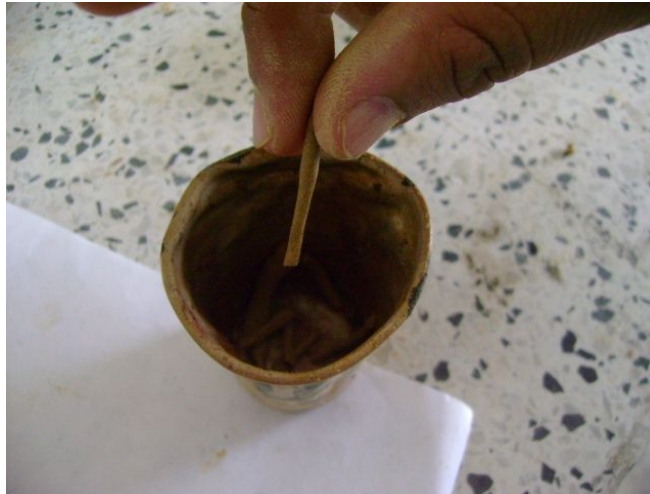
Foto 2.4.2-16: Llenado de tara con trozos de cilindros de material.
