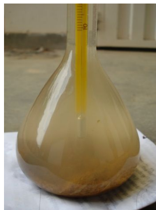
Foto 2.10-29: Medida de la temperatura del frasco mas muestra.
