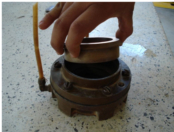
Foto 2.11-19: Colocación del anillo de cobre.
