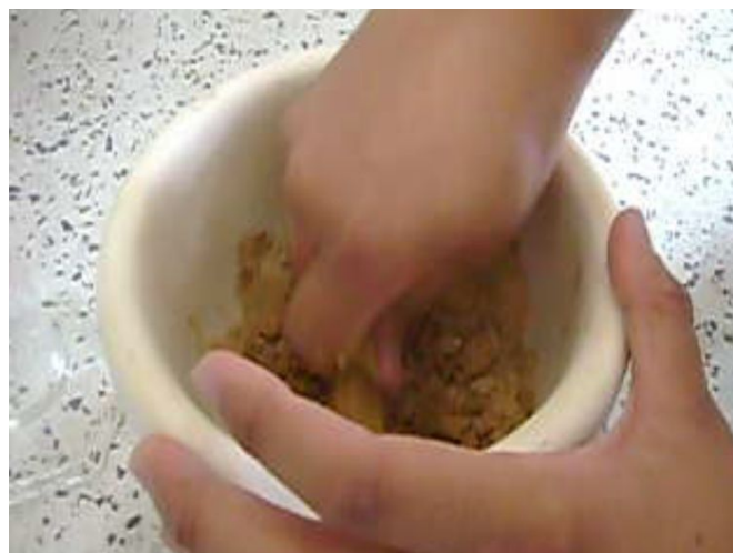
Foto 2.4.1-15: Preparación de mezcla en la vasija para ensayo de límite líquido
