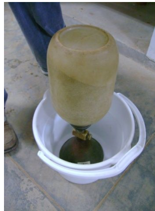
Foto 2.8-8: Determinación de la arena en el embudo.
