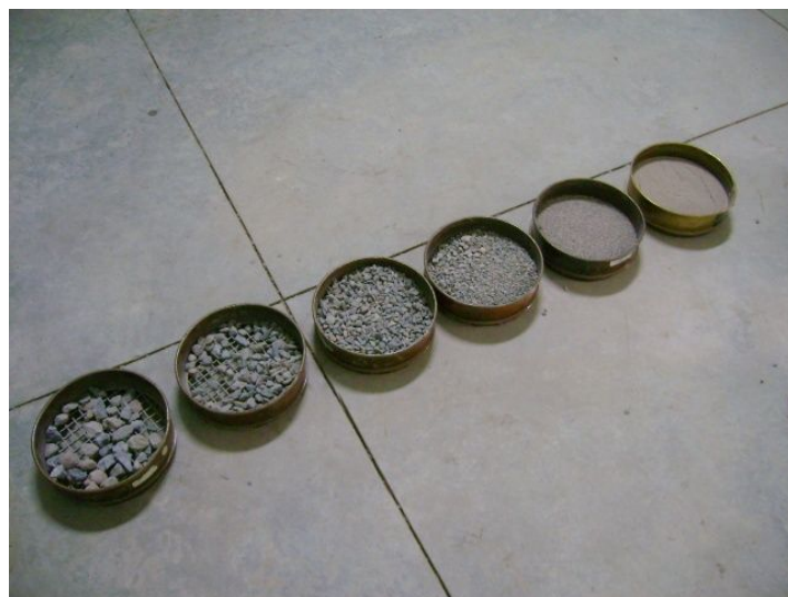
Foto 2.3.1-13: Muestra retenida en cada tamiz después del tamizado a maquina.
