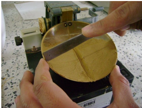
Foto 2.4.1-21 y 2.4.1-22: Trazo de línea perpendicular a la ranura
