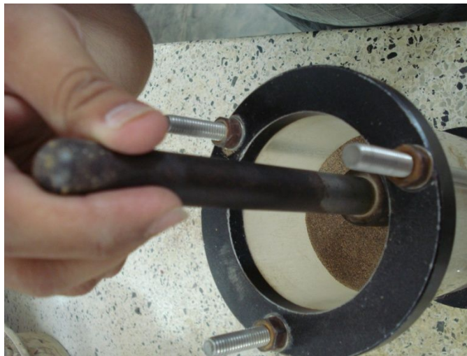
Fotografía 2.9.1-20: compactación de la quinta capa.
