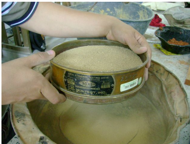
Foto 2.4.1-12: Muestra tamizada por malla No 40
