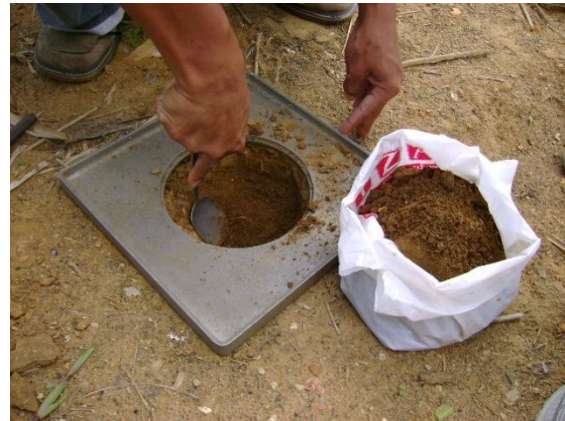
Foto 2.8-9 y 2.8-10: Demarcación, excavación y toma de muestra del hueco
