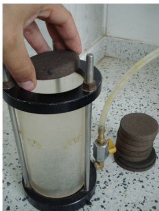
Fotos 2.9.1-16 y 2.9.1-17: Colocación del espesor poroso inferior.
