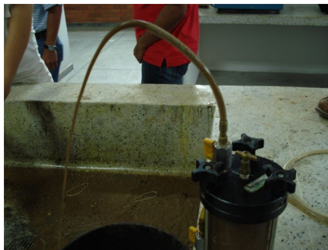
Foto 2.9.1-26: Flujo de agua a través de la válvula superior.
