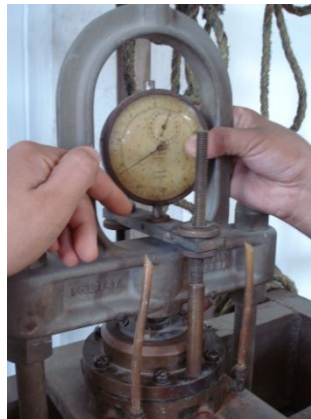
Foto 2.11-28: Colocación del extensómetro.
