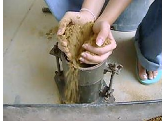
Foto 2.7-17 y 2.7-18: Vaciado de muestra en molde.
