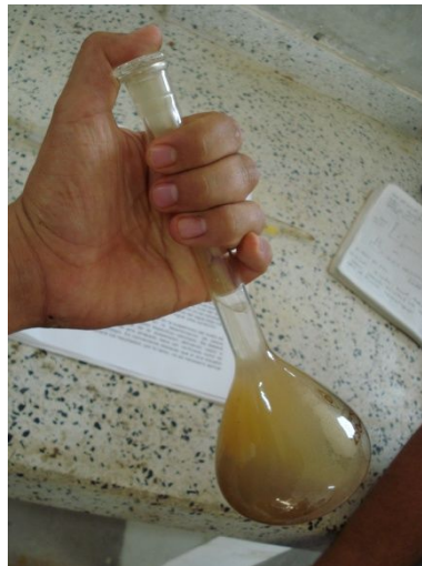
Foto 2.10 -30: Rotación del frasco de arriba hacia abajo.
