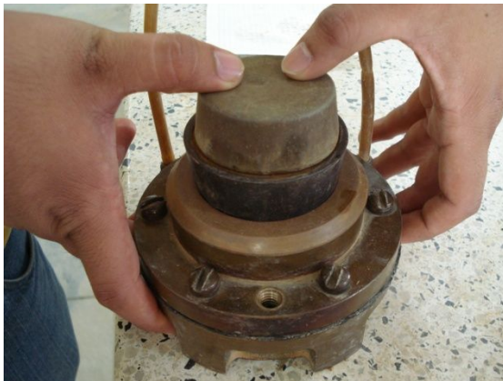
Foto 2.11-21 y 2.11-22: Incrustación de muestra dentro de la caja de consolidación.
