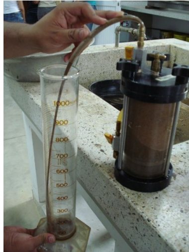
Foto 2.9.1-27: Medición del gasto en la probeta de 200cm 3 .
