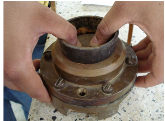
Foto 2.11-21 y 2.11-22: Incrustación de muestra dentro de la caja de consolidación.
