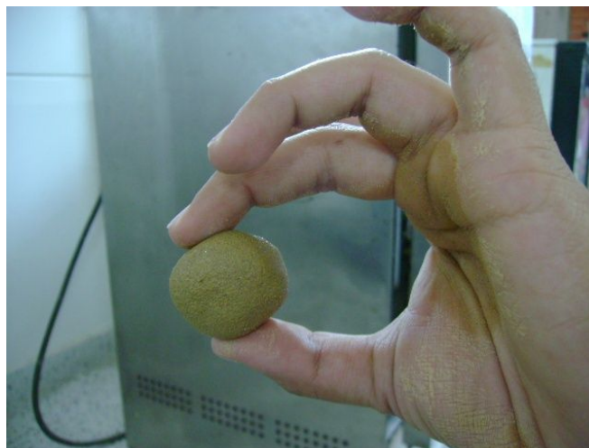
Foto 2.4.2-11: Humedad requerida para el ensayo (Esfera de barro).
