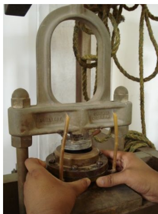
Foto 2.11-26: Colocación de la caja dentro de la maquina de carga.
