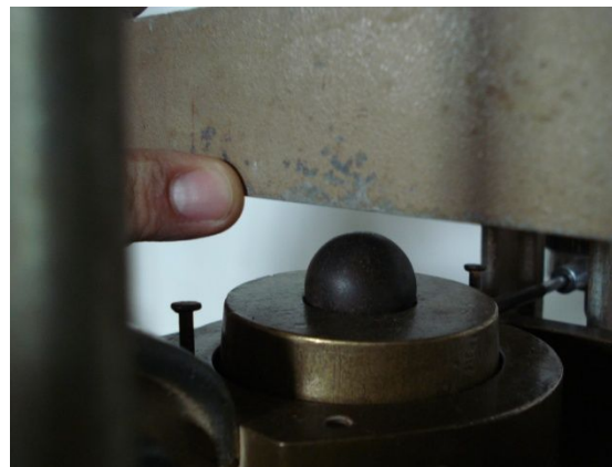
Fotos 2.5-21 y 2.5.22: sistema de carga ubicado correctamente.
