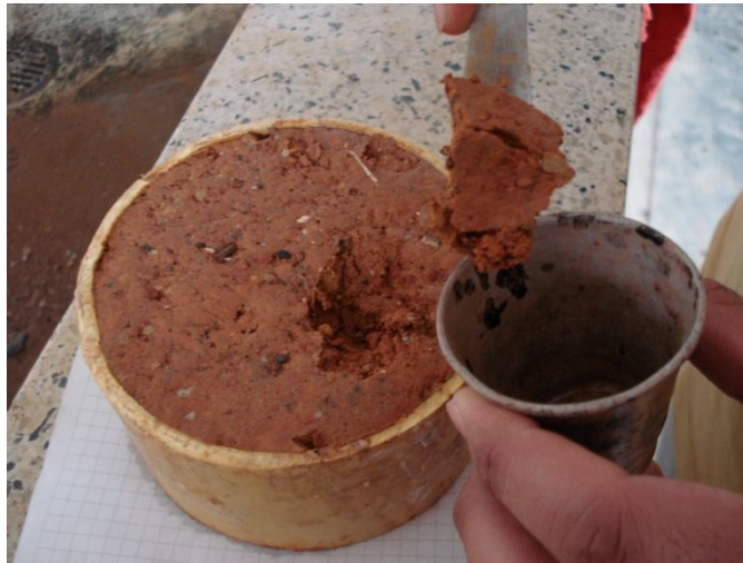
Foto 2.1-5: Vaciado de muestra de suelo en una tara.
