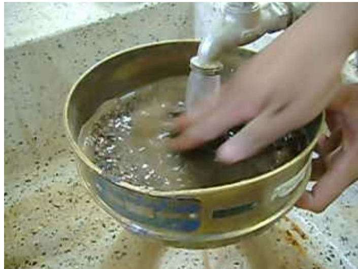
Foto 2.3.1-9: Lavado de muestra retenida por el tamiz No 200.
