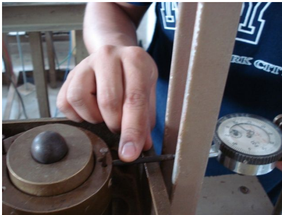
Fotos 2.5-24 y 2.5-25: Colocación del deformímetro.
