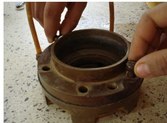
Foto 2.11-15 y 2.11-16: Preparación del Consolidómetro.
