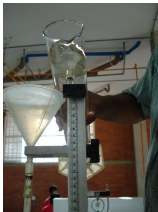
Foto 2.9.1-3: Embudo, probeta y manómetro.
