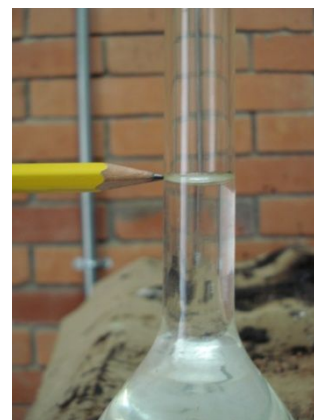
Foto 2.10-14 y 2.10-15: Nivel del agua concordando con la marca de calibración.
