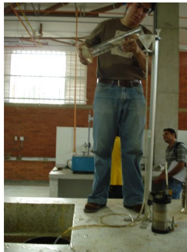
Foto 2.9.1-24: Flujo inicial de evacuación de aire en la manguera.
