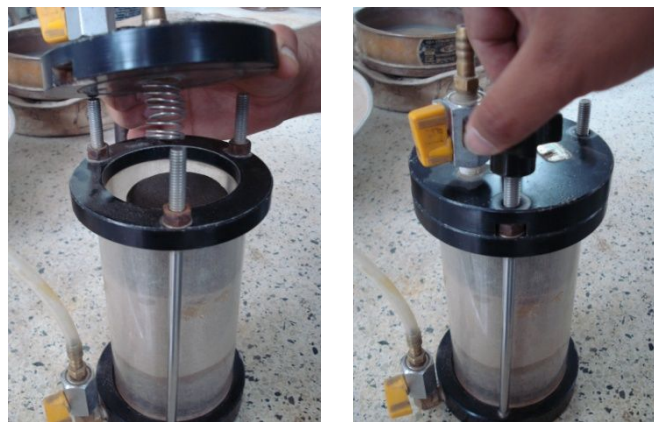
Fotos 2.9.1-21 y 2.9.1-22: Colocación de sello a prueba de aire.
