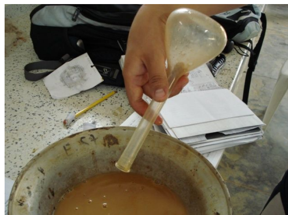
Foto 2.10-31 y 2.10 -32: Vaciado de la mezcla en un platón.
