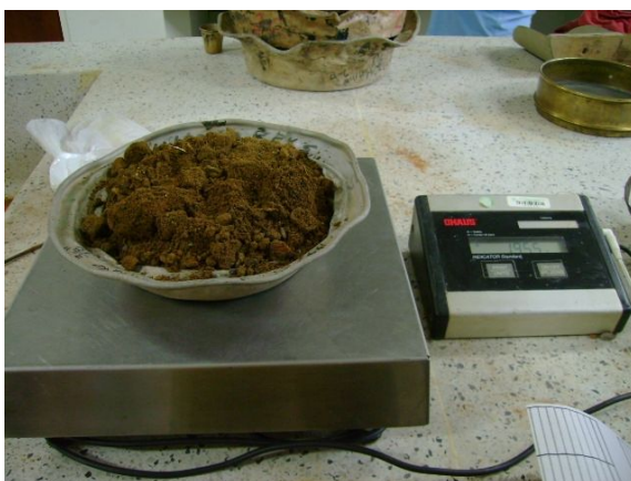
Foto 2.8-16 y 2.8-17: Peso del suelo removido y de la arena que quedo después de la excavación.
