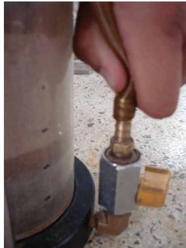
Foto 2.9.1-25: Conexión de manguera a válvula inferior.
