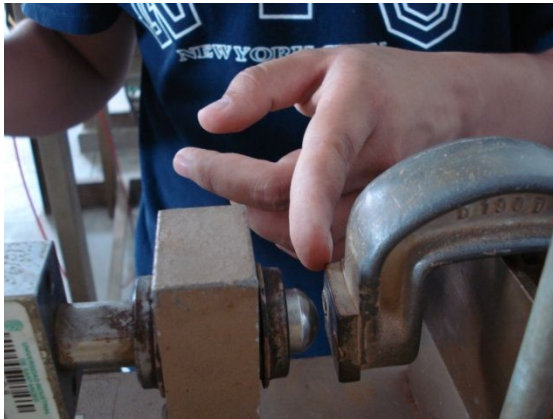
Fotos 2.5-26 y 2.5-27: Brazo de carga contra parte móvil de la caja y Lector de carga en ceros.
