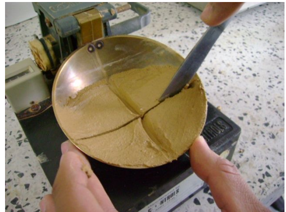
Foto 2.4.1-21 y 2.4.1-22: Trazo de línea perpendicular a la ranura
