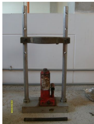
Foto 2.7-3: Dispositivo para extracción de muestras
