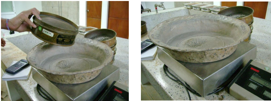
Foto 2.3.1-14 y 2.3.1-15: Vaciado y peso de muestra retenida en un tamiz.
