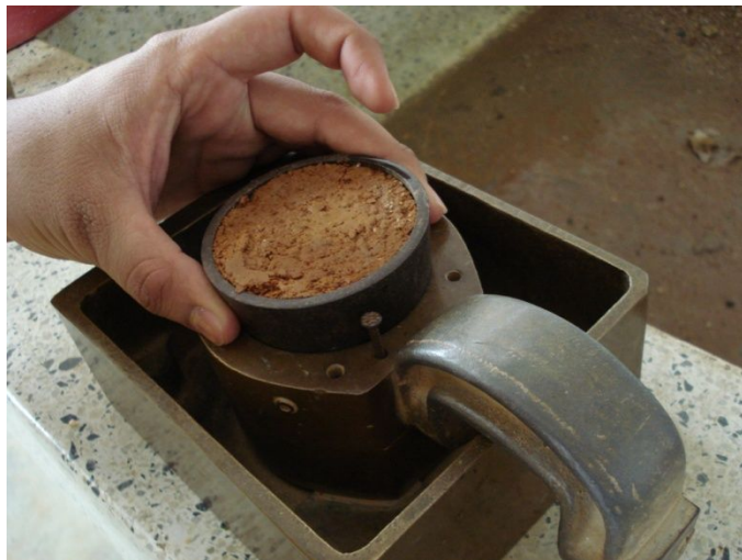
Foto 2.5-16: Colocación de anillo
