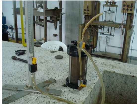
Foto 2.9.2-2: Manguera conectada al permeámetro
