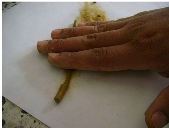
Foto 2.4.2-13: Formación de cilindros de material humedecido.
