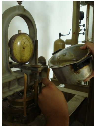
Foto 2.11-30: Vaciado de agua dentro de manómetros.
