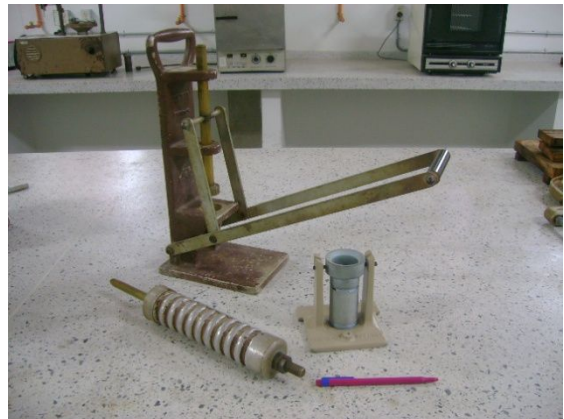
Foto 2.6-2: Extractor de muestras + molde de probetas
