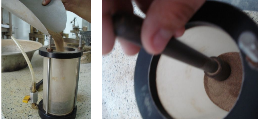
Fotos 2.9.1-18 y 2.9.1-19: Vaciado y compactación de la primera capa.
