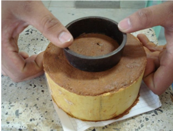
Foto 2.11-13 y 2.11-14: Extracción del anillo mas muestra.
