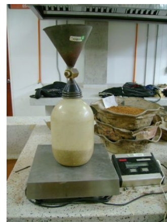
Foto 2.8-16 y 2.8-17: Peso del suelo removido y de la arena que quedo después de la excavación.
