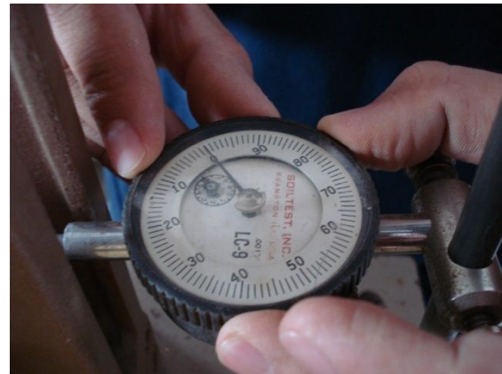
Fotos 2.5-24 y 2.5-25: Colocación del deformímetro.
