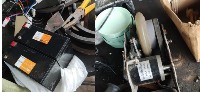
Baterías y Motor Eléctrico del Prototipo
