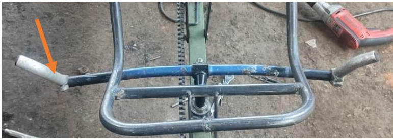
Montaje Incorrecto del Tubo de Dirección
