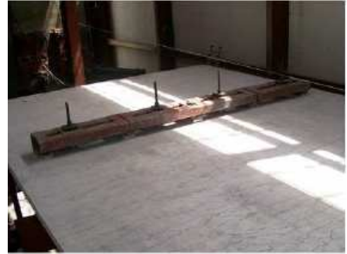
b) Descascaramiento en la zona de rótula plástica superior
