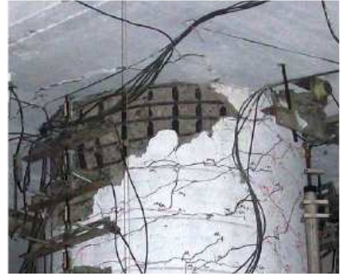
b) Descascaramiento en la zona de rótula plástica superior
