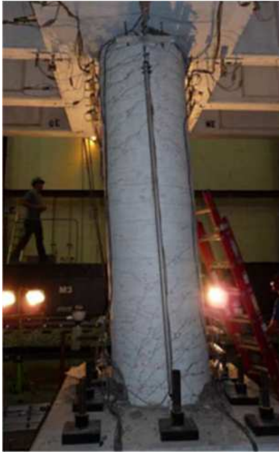
a) Columna sometida a 180mm de desplazamiento
