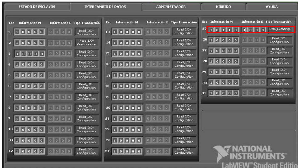
Figura 4.8 Pantalla Del Analizador Detectando un Esclavo Diseñado por el Grupo AS-/UIS y Su Respectiva Transferencia de Datos
