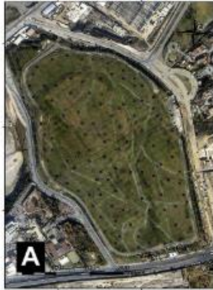
Figura 17. Sistema de extracción de biogás en el relleno sanitario de Prados de la montaña, México. Los puntos negros representan los tubos de extracción. Nota. Tomado de: “Energy production from biogas in a closed landfill: A case study of Prados de la Montaña, Mexico City”
