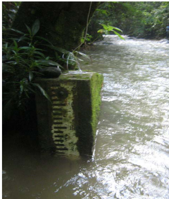
Figura 6. Mira localizada 20 m aguas debajo de la estación automática
