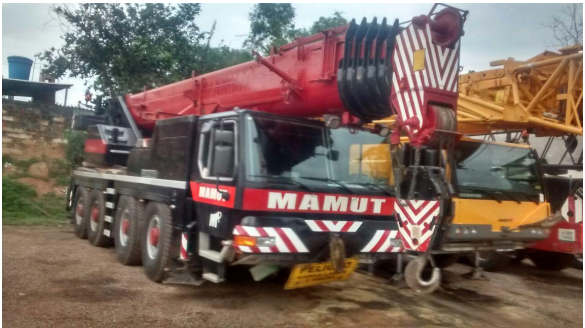
Figura 2. Grúa LIEBHERR LTM 1080 DE SERIE 61439
