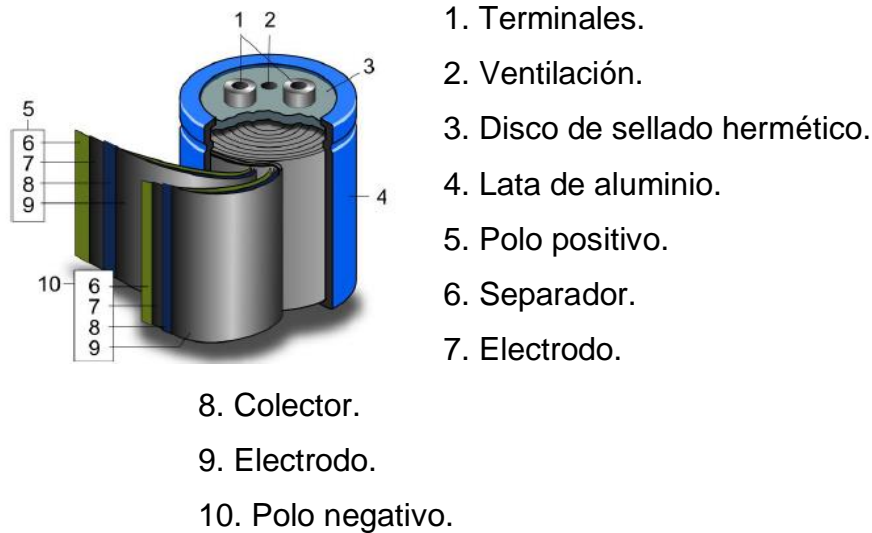
Figura 3. Detalles constructivos de un supercondensador.
