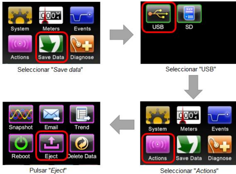
Figura 9. Descripción gráfica del procedimiento para la descarga de datos empleando dispositivo USB - PQube 3.
