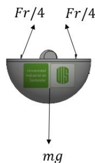
Figura 5. Diagrama de cuerpo libre de la góndola.
