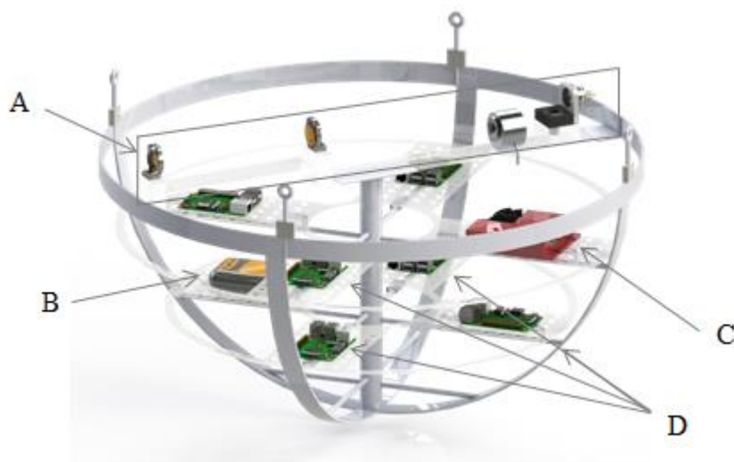
Figura 7 Distribución de la instrumentación en los tres niveles de soporte al interior de la góndola.
