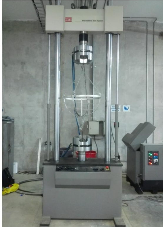
Figura 33 Prueba a tracción de la estructura. En la imagen se muestra el montaje en la máquina de ensayos de tracción.
