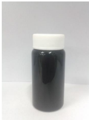
Figura 14. Óxido de grafeno después de la reacción con microondas.
