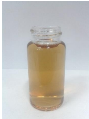
Figura 13. Solución de GO antes de la reacción hidrotérmica.
