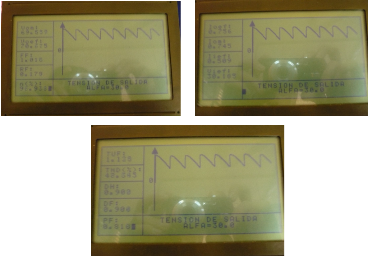
Figura B1: Visualización de parámetros y forma de onda de salida para el control por ángulo de retraso con \alpha = 30^\circ
