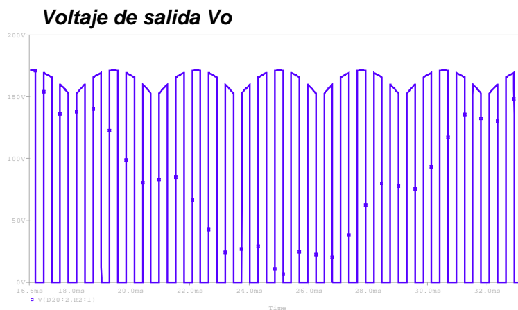
Figura 9. Voltaje de salida del rectificador trifásico controlado aplicando el control por modulación de ancho de pulso de 1.8kHz y ciclo de trabajo de 50%.
