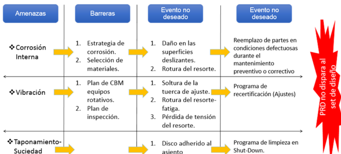
Esquema para el manejo de riesgos de los dispositivos de alivio de presión
