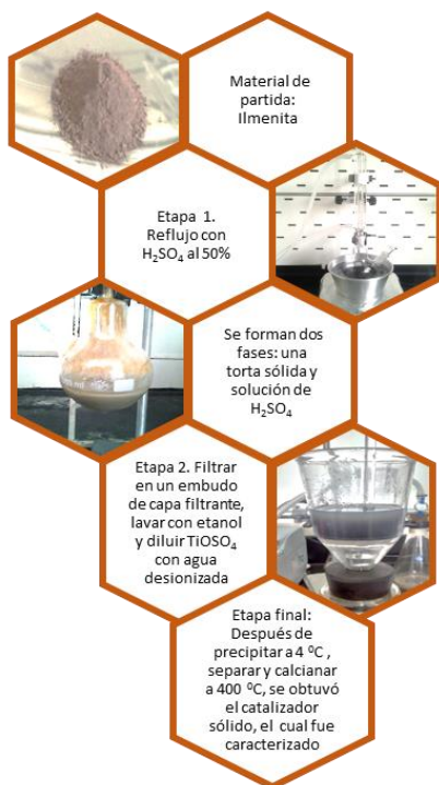
Figura 15. Preparación de \text{TiOSO}_4 -1
