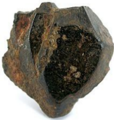
Figura 11. Ilmenita y sus propiedades físicas
