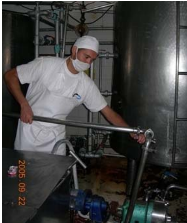
Figura 29. Ensamble y Esterilización de Tubería.
