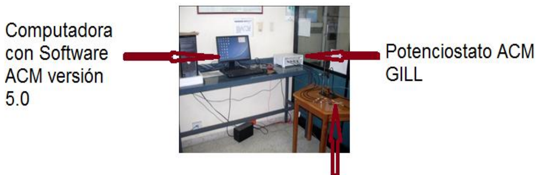
Figura 13. Fotografía de la celda conectada al potencióstato ACM Gill conectado a una computadora con software ACM versión 5.0
