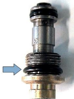
Figura 5. Sello (O-ring) de caucho nitrilo en la válvula reguladora de presión: hinchamiento y deformación
