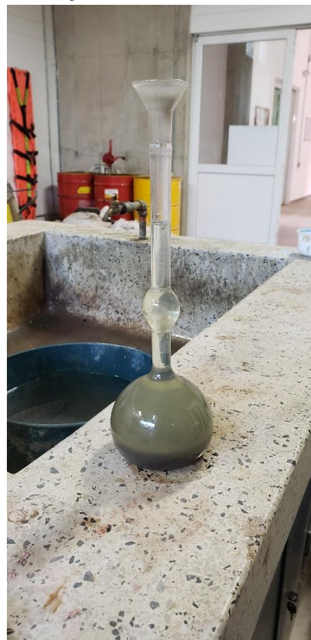
Figura 17. Frasco de Le Chatelier con muestra ya estabilizada
