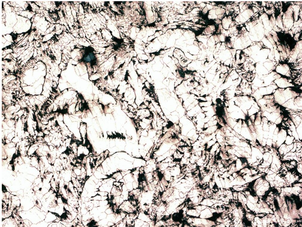
Figura 8. Micrografía Magnesio 1% en volumen de esferas huecas de SiC. Tomada a 100X.
