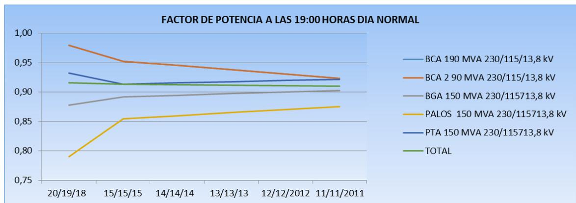
Tabla 7 Factor de potencia en los autotransformadores con carga.
