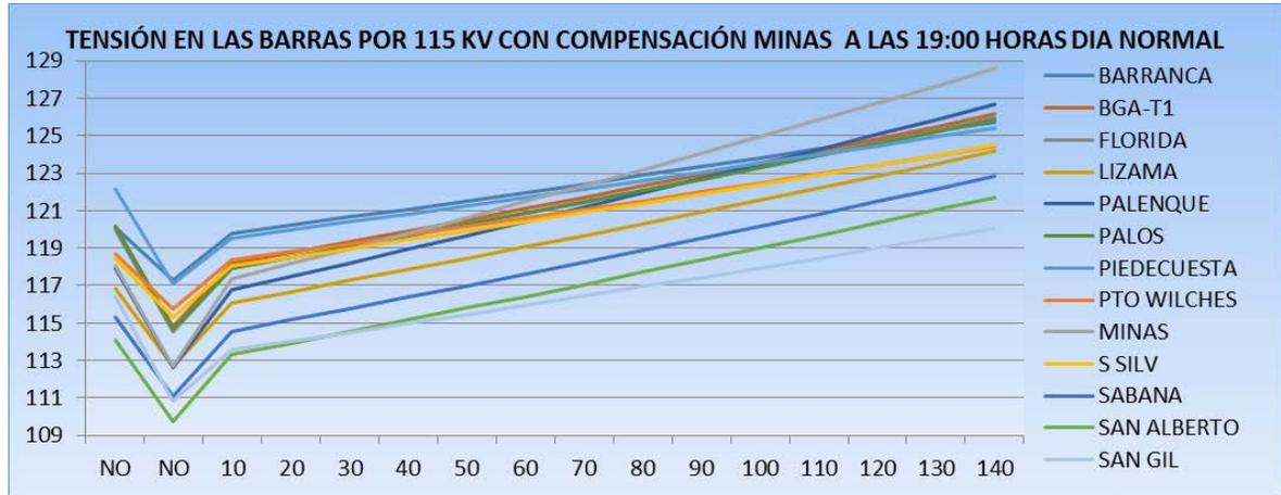
Tabla 31 Comparativo de la tensión en las barras por 115 kV, variando el valor de la compensación en la barra de 115 kV de la subestación Minas.
