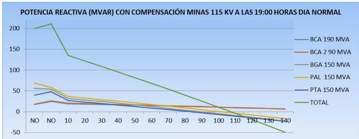
Tabla 28 Comparativo de la potencia reactiva en las barras por 230 kV, variando el valor de la compensación en la barra de 115 kV de la subestación Minas.
