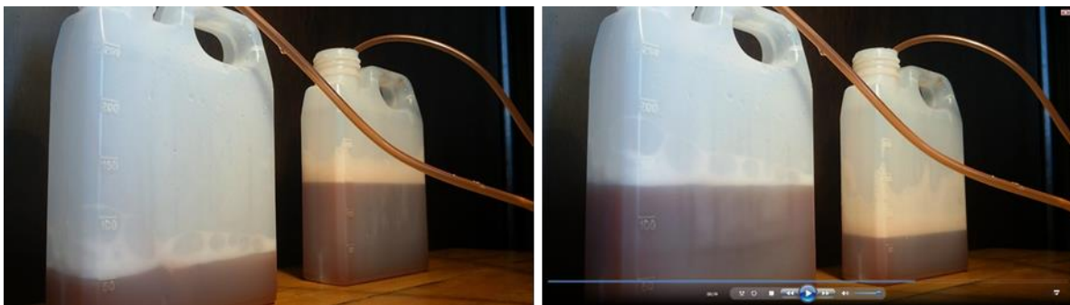
Figura 50. Traslase de mezcla que simula la viscosidad de la sangre.
