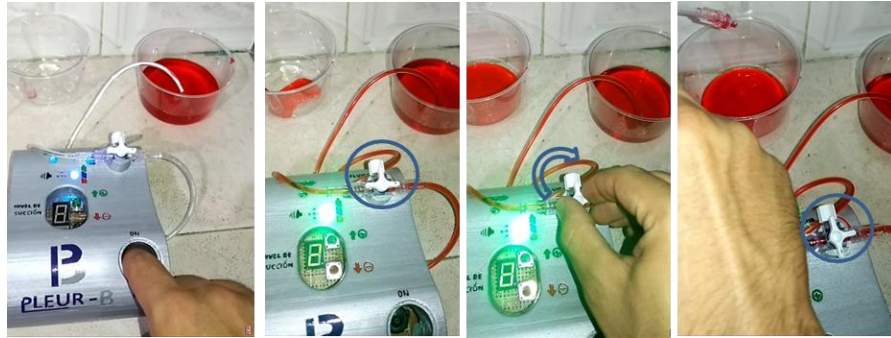
Figura 52. Comprobación de funcionamiento sistema antitrasvase dispositivo Pleur-B.
