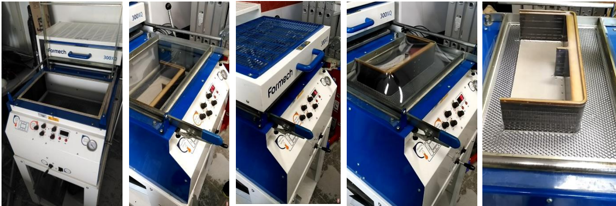
Figura 70. Ejemplificación del modelo productivo de termo formado por cámara de vacío implementado para el desarrollo del empaque primario del dispositivo Pleur-B.
