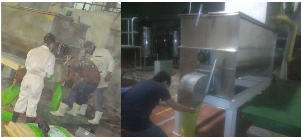
Figura 46. Antes y después de la instalación de la boquilla en la mezcladora
