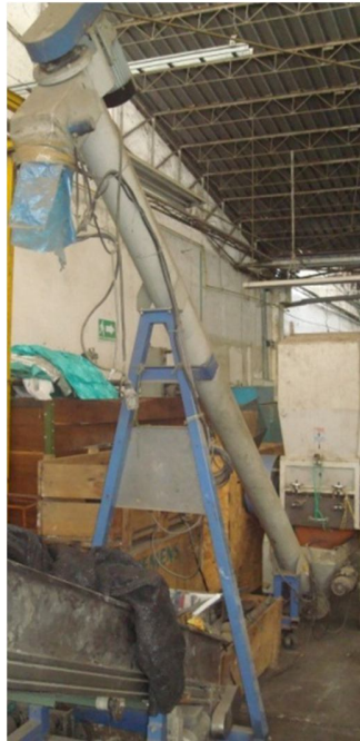
Figura 43. Avance del tornillo Sinfín
