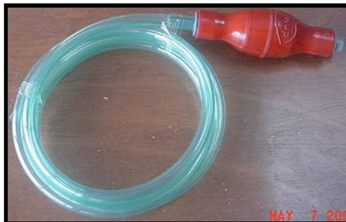
Figura 28. Manguera con bomba de succión
