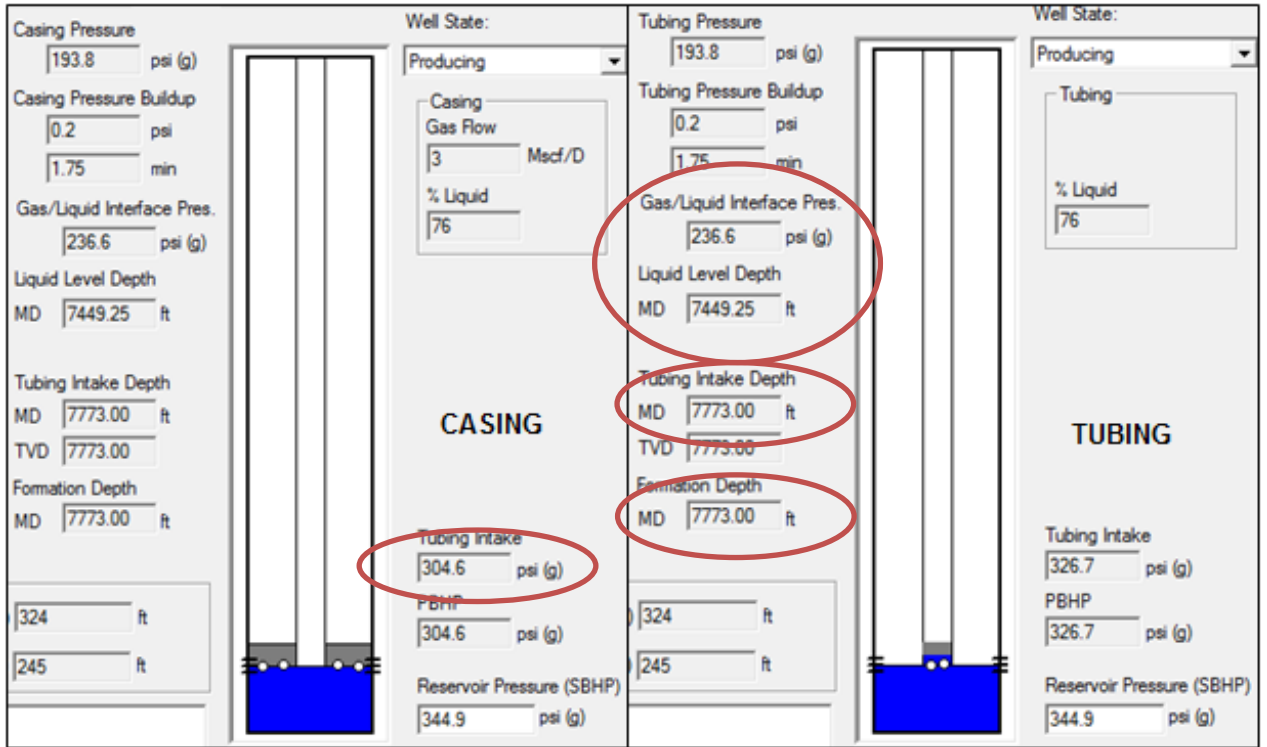
FIGURA 82. Sonolog pozo T1. Sección BHP para implosión por casing y tubing, software TWM.
