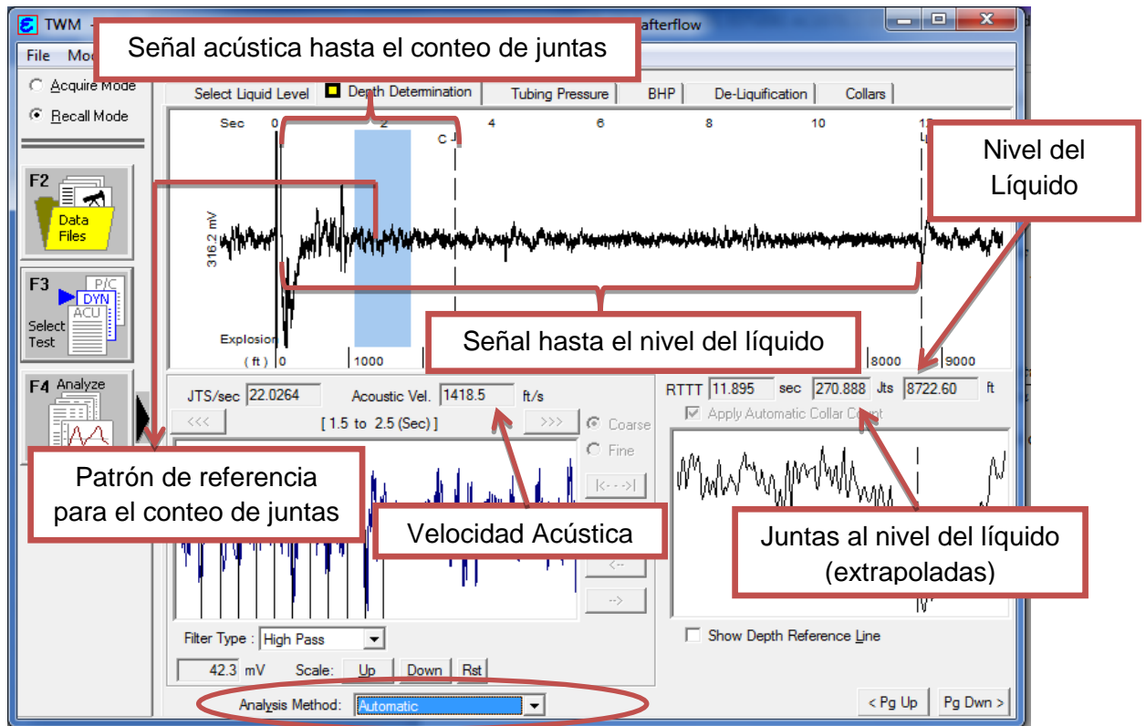
FIGURA 73. Sonolog pozo T1. Determinación de la profundidad del nivel de líquido por el método automático.
