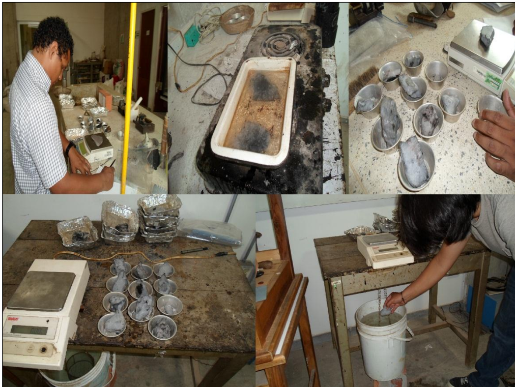
Figura 34. Procedimiento para determinar densidad de las muestras. Normas ASTM E-145 y ASTM 2216-98.
