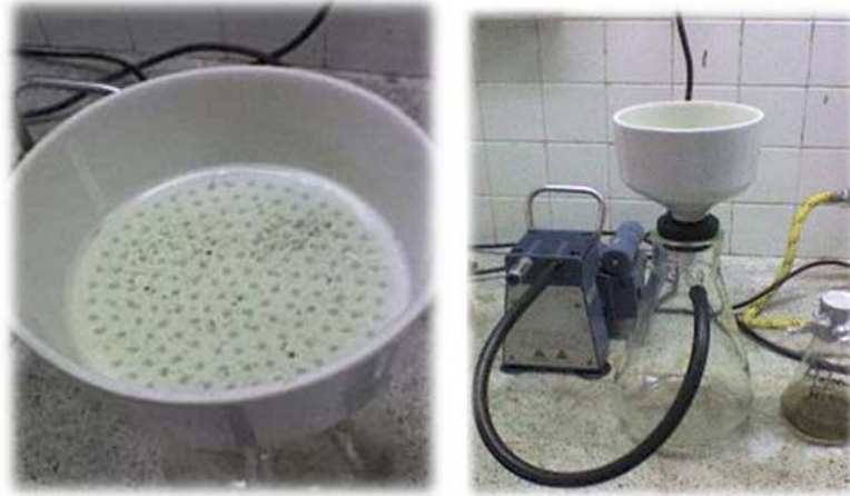
Figura F5. Filtración a vacío para la etapa de pretratamiento y la etapa de hidrólisis
