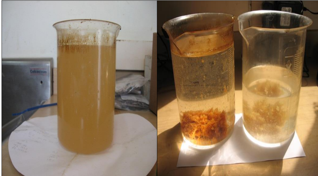
Figura 60. Muestra de ARI sin tratar y tratada, Muestras tomadas en la salida de los skim tank, Pruebas Campo Cabiona
