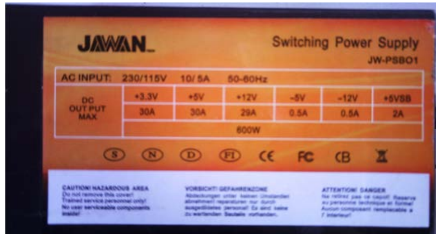
Figura 41. Salidas de potencia de la fuente
