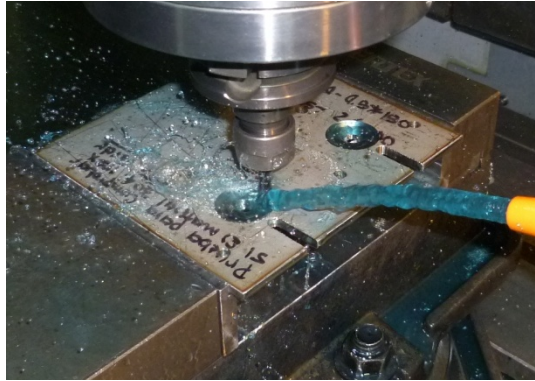
Figura 54. Mecanizado Placas del Soporte Motorreductor Inferior.
