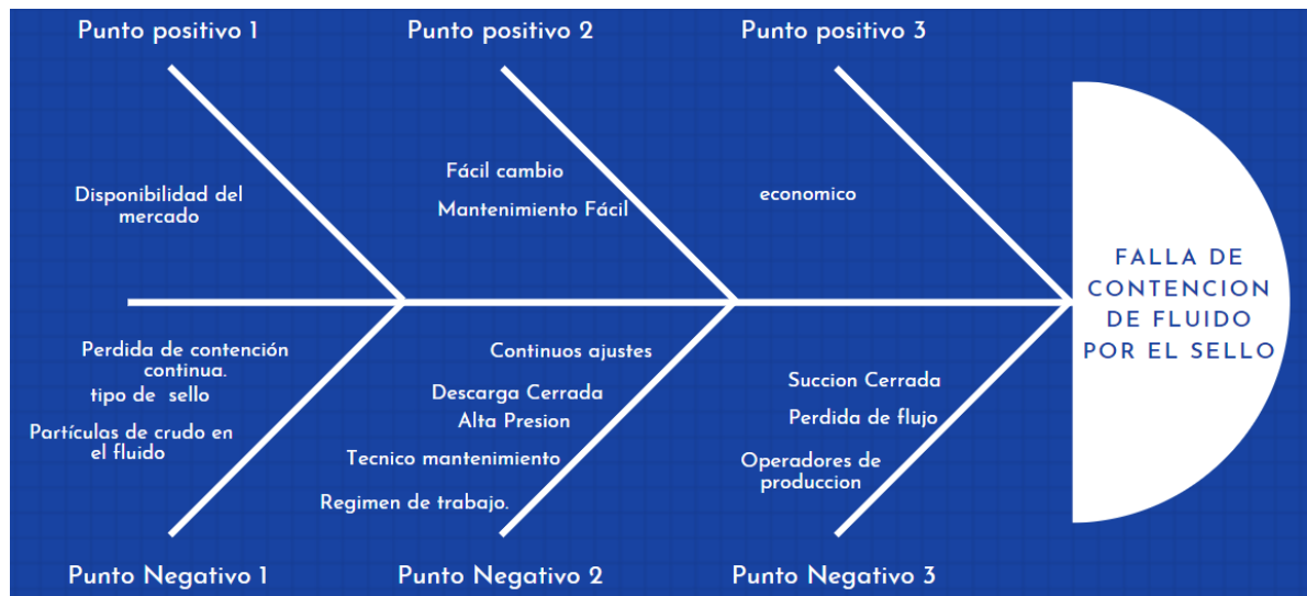
Figura 24 Factores positivos y negativos de sellos prensaestopas
