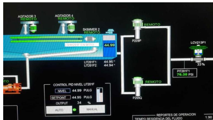
Figura 3 Celda de flotación y bombas de agua a piscinas
