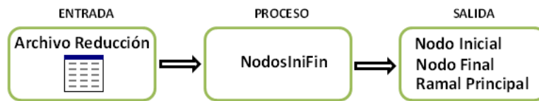
FIGURA 4.5.: Entradas, proceso y salida de la función «NodosIniFin»
