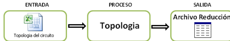
FIGURA 4.3.: Entradas, proceso y salida de la función «Topologia»
