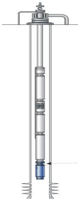
Figura 12. Estado mecánico con sensor tipo 0
