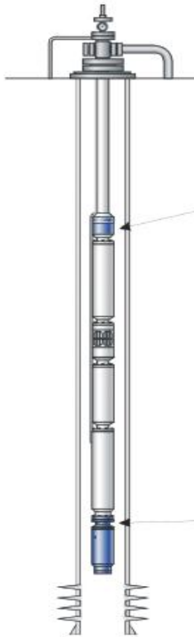
Figura 13. Estado mecánico con sensor tipo 1.
