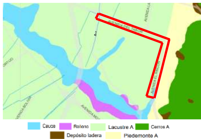
Figura 15. Caracterización Suelos Obra Rincón-Tabor
