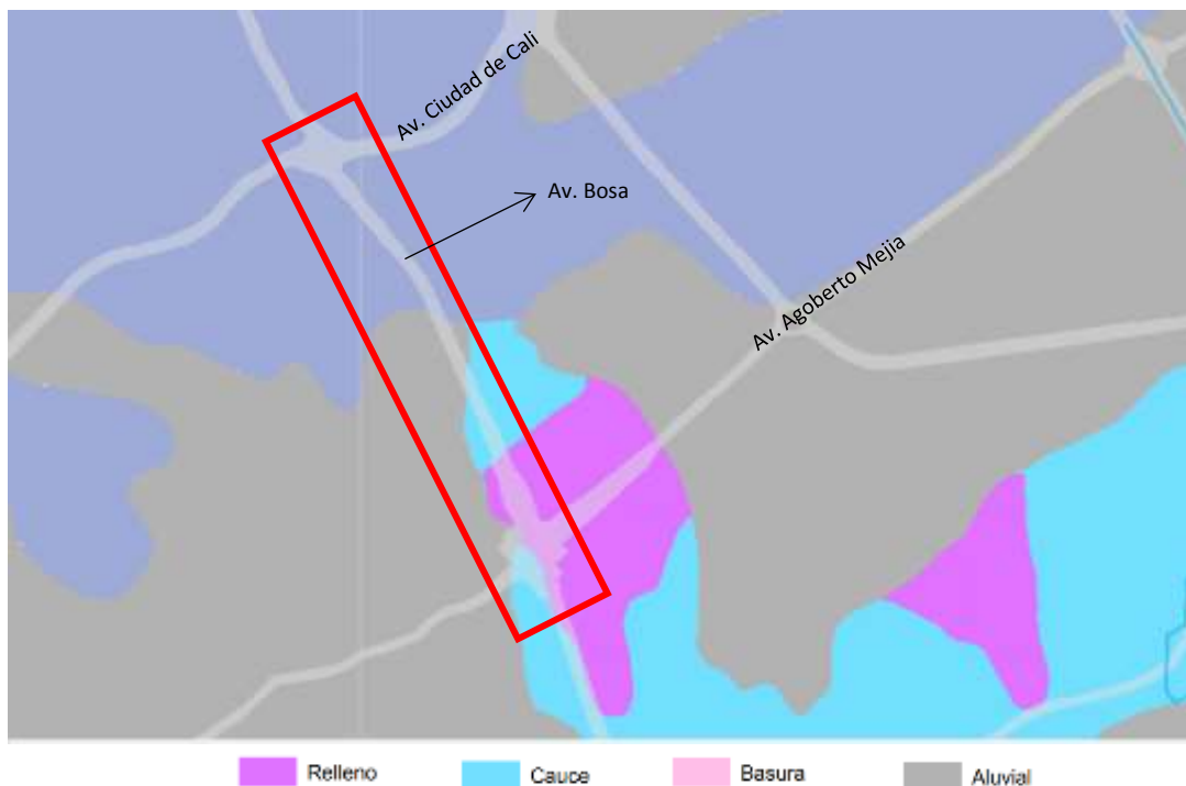
Figura 11. Caracterización Suelos Obra Av. Bosa
