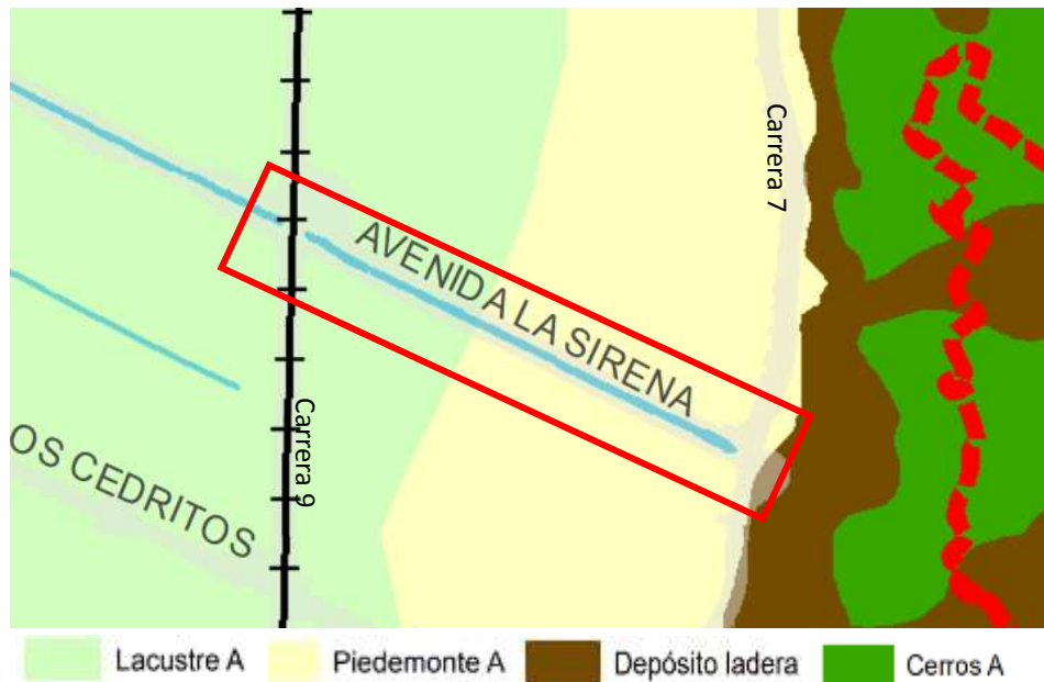
Figura 17. Caracterización Suelos Obra Av. la Sirena
