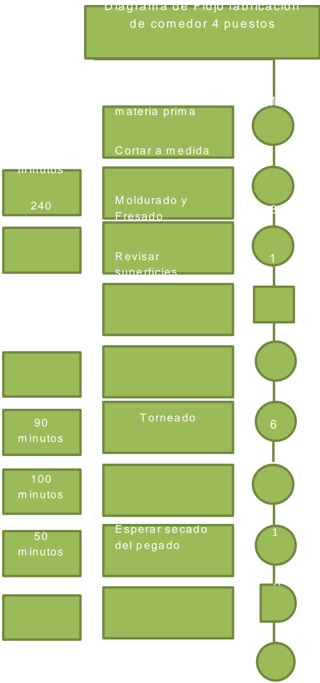
Figura 1. Diagrama de flujo fabricación de comedor de 4 puestos
