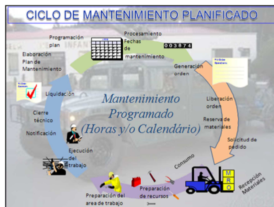
Figura 73 Ciclo Mantenimiento Planificado en SAP-PM
