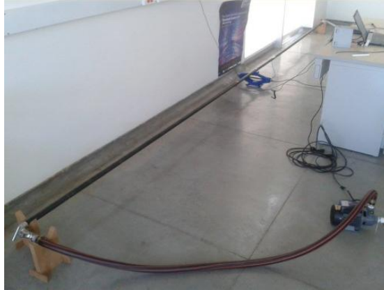
Figura 21: Montaje experimental para producir deformaciones elásticas en una tubería
