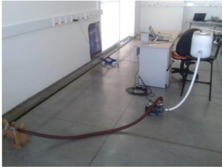
Figura 33: Laboratorio de pruebas deformaciones en condiciones de flujo estable Los índices estadísticos calculados para los escenarios de deformación a tres velocidades de flujo diferente se muestran en la figura 32. Se observa que a menor velocidad de flujo los índices estadísticos T^2 y Q son mayores.
