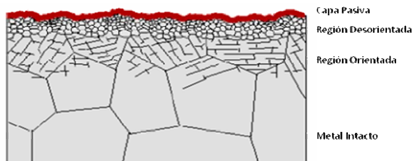
FIGURA 1. Diagrama del corte transversal de un acero inoxidable. [1]
