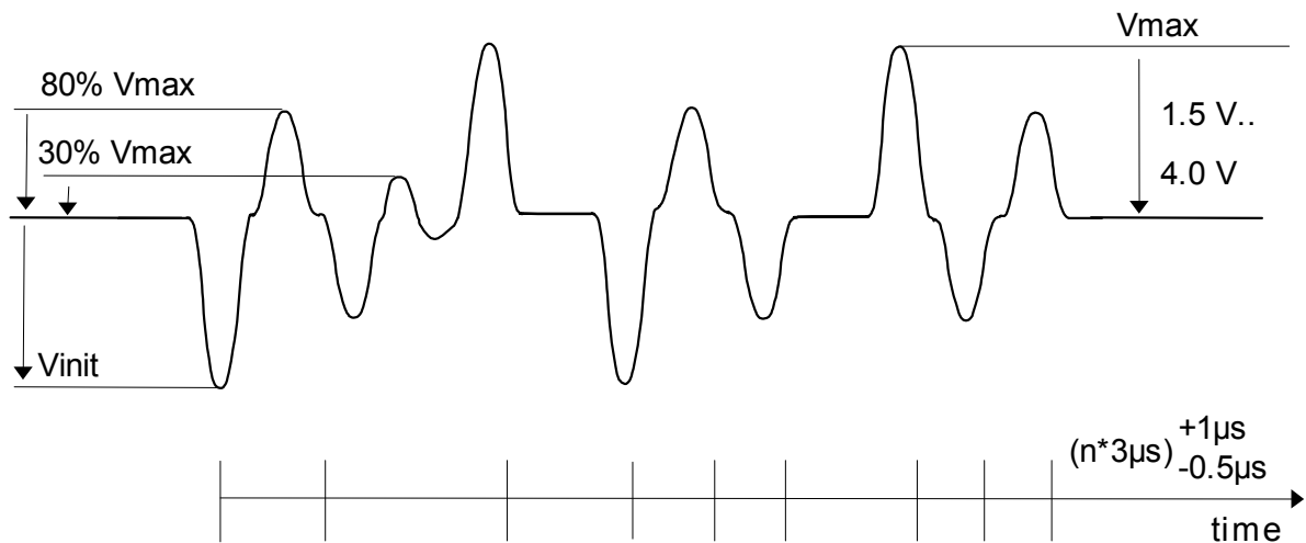
Figura 3.7: Requerimientos del Receptor AS-i.
