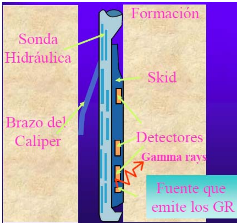
Figura 2.1. Esquema de la herramienta y principio del registro de densidad. Tomado Mantilla y Bueno (2005), Registros de pozo; herramientas, interpretación y aplicaciones.
