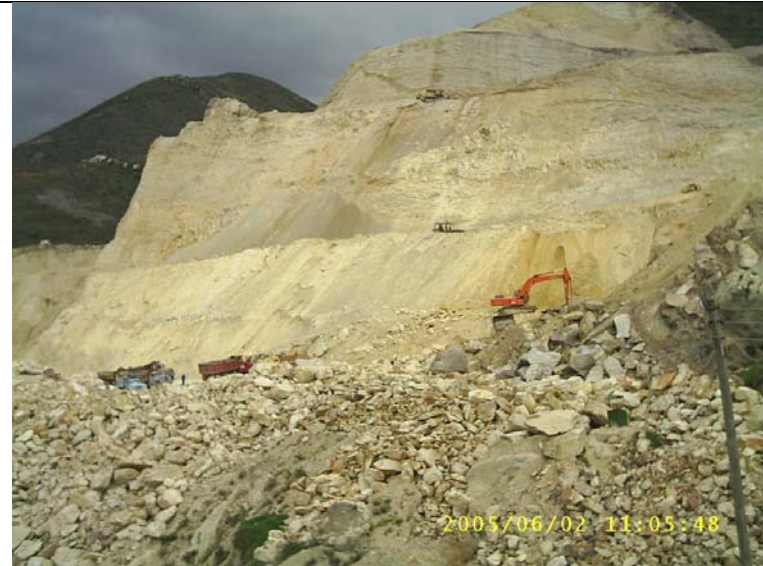
Cantera CUEVA DEL ZORRO, terraceo para la explotación, nótese el corte en contra del buzamiento (ángulo que forma la formación geológica)
