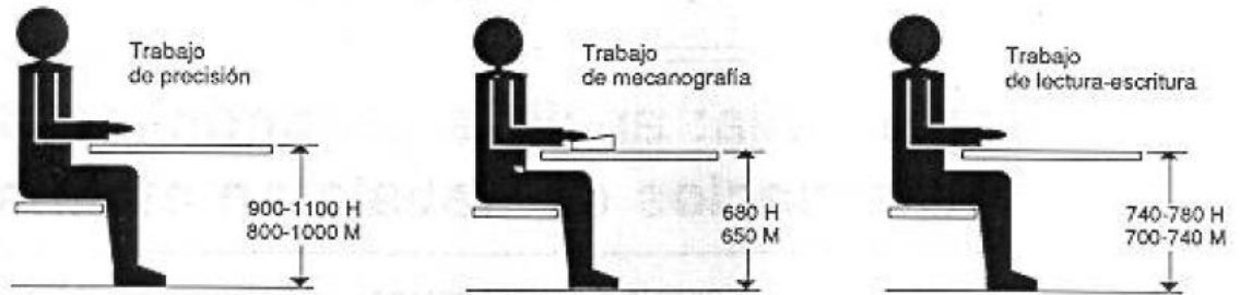
Fig. 1: Altura del plano de trabajo para puestos de trabajo sentado (cotas en mm)
